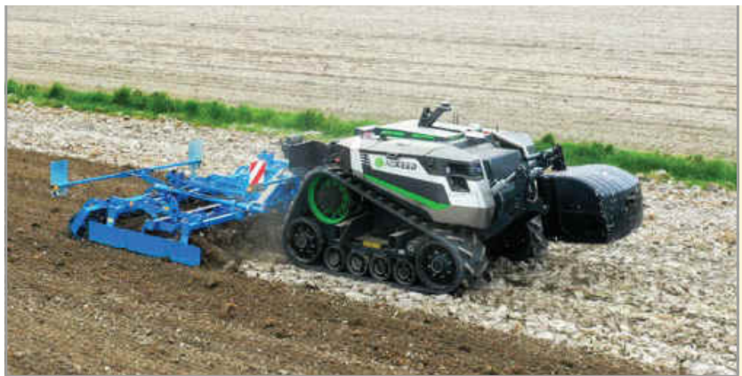
Der AgBot, hier zu sehen mit einer Saatbettkombination, bietet durch Sensoren und ein zertifiziertes GPS-System größtmögliche Sicherheit.
