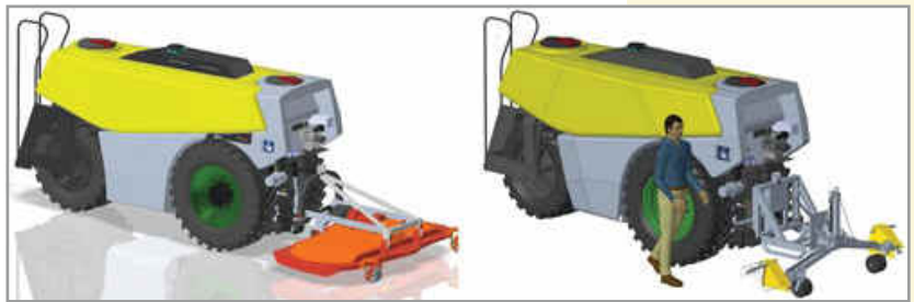
Bei der Arbeit mit einem Kreiselmulcher und einer Unkrautspritze fährt der AgBot 3x2 rückwärts.
