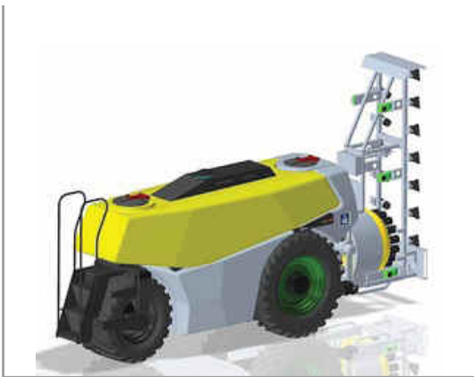
Een impressie van de AgBot 3x2: de onbemande smalspoorrobot voor de fruitteelt
