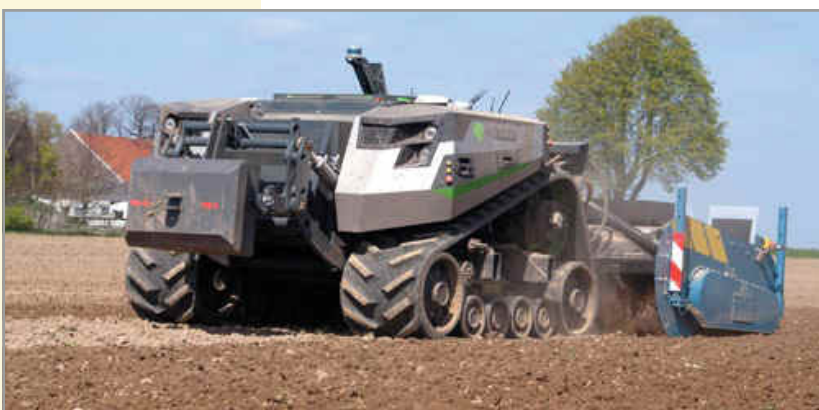
De AgBot van AgXeed in actie met een spitmachine
