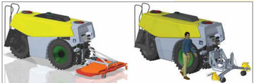
Voor het werken met een cirkelmaaier en onkruidspuit rijdt de AgBot 3x2 achteruit.
